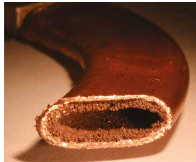
Figuur 3: In een apparaat zoals een laptop wordt bijna altijd een sintered heatpipe toegepast, omdat niet is te garanderen dat de vloeistofstroom altijd horizontaal loopt.
